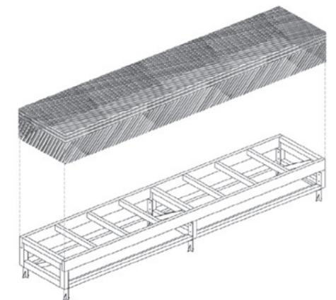
Comme sur la plupart de nos productions actuelles, les charpentes sont maintenant réalisées en bois lamellé-collé. Seuls les piétements de fixations au sol sont en acier galvanisé. Les bancs sont retro-éclairés par des linéaires LED intégrés aux bancs pour signaler les circulations piétonnes.
