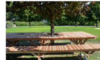
Le mobilier est entièrement réparable et démontable, et posé sur des vis de sol, qui permettent de ne pas gêner le système racinaire des érables, de préserver un sol poreux, et de réutiliser les fondations en fin de vie du mobilier. Le bois est issu d'anciennes portes et fenêtres d'extérieur.
