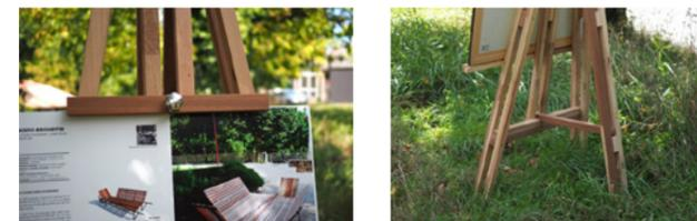
Conçu sur un modèle standard de chevalet, ECho1 a cependant la particularité d'avoir des pieds et des montants dédoublés, ce qui lui confère légèreté, et robustesse. Les éléments sont assemblés par entretoises, tel un mécano. L'ensemble est pliable pour le stockage. Toutes les pièces de métal et les visseries sont en inox A4.
