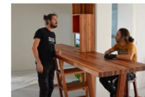
Comme l'ensemble de nos mobiliers, le mange-debout est constitué d'un assemblage de modules: Un plateau principal, deux piétements d'extrémité, un piétement central de rangement, et une colonne de rangement central. Le plateau faisant bar est d'épaisseur double (alèse périphérique).
