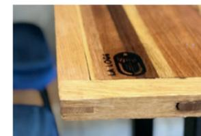
Les éléments sont réalisés en lamellé-collé de bois d'essences variées, issu d'anciennes menuiseries, et cadrées par un châssis en chêne brossé. Le logo du café est marqué au fer chaud, avant l'application de la finition huilée. La texture et les teintes fortes du mobilier contrastent agréablement avec la pierre du bâti rénové, et le bar en céramique.
