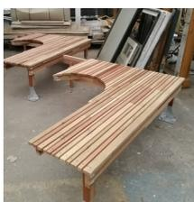
La plateforme est composée de deux modules (voir axonométrie), entièrement préfabriqué à l'atelier, qui une fois assemblés sur site permettent de créer le mobilier autour d'un arbre. Le mobilier est adapté aux «cours Oasis», il propose un îlot de fraîcheur, en laissant un sol poreux et végétal.
