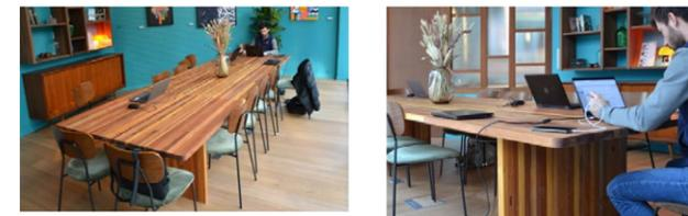
Le plateau est confectionné en 3 parties, de manière à pouvoir manipuler les éléments, les assembler avec les piétements et les poutres centrales, à 2 personnes. Toutes les parties sont livrées à plat, assemblées par inserts métalliques, avec notice de montage.
