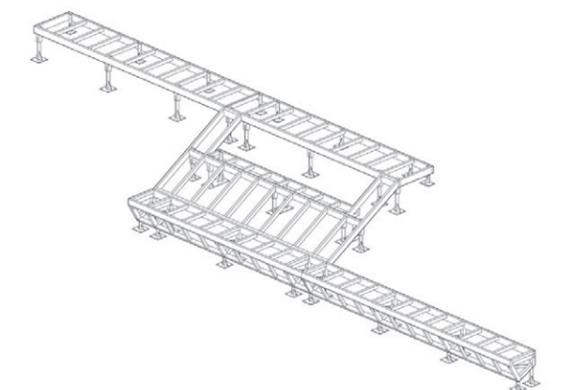
Ce projet est l'occasion pour nous de fabriquer une structure porteuse en lamellé-collé surcyclé. Les platines métalliques maintiennent discrètement les éléments hors sol. Les éléments ont été préfabriqués dans nos ateliers, puis transportés et assemblés sur place par tronçons.
