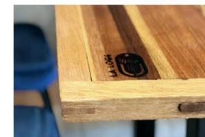
Les éléments sont réalisés en lamellé-collé de bois d'essences variées, issu d'anciennes menuiseries, et cadrées par un châssis en chêne brossé. Le logo du café est marqué au fer chaud, avant l'application de la finition huilée. La texture et les teintes fortes du mobilier contraste agréablement avec la pierre du bâti rénové, et le bar en céramiques modulaires.
