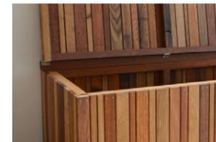
Les panneaux d'ossature sont assemblés à tenons et mortaises et sont à assembler entre eux par l'utilisateur à l'aide de vis métaux et inserts. Les lames de bardage sont fixés sur l'ossature à l'aide de pointes en Inox.
