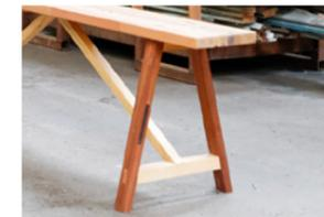
L'assise, étroite, est constitué d'un lamellé-collé de 27mm d'épaisseur. Deux portiques complétés de jambes de forces constituent le piétement parfaitement stable de ce banc particulièrement léger à déplacer. Ce mobilier d'intérieur supporte d'être utilisé ponctuellement en extérieur.
